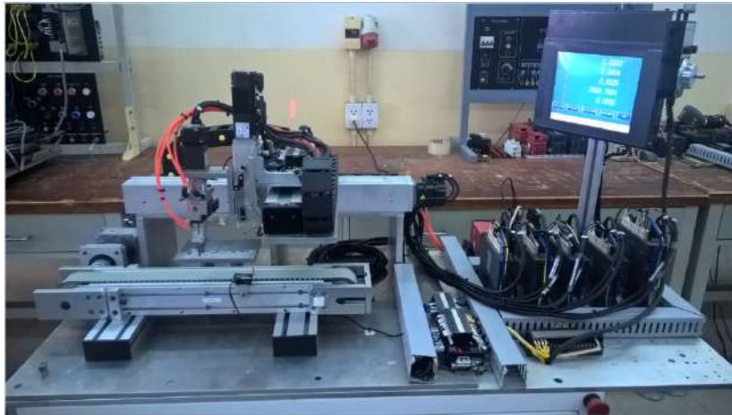
Mô hình Flying Shear : Cắt vật đang chuyển động
