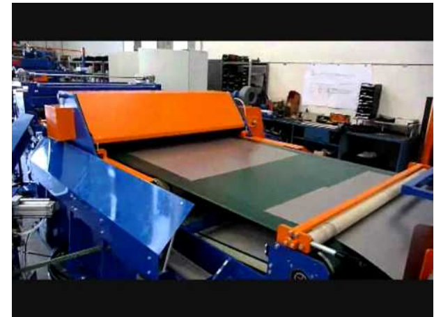
Mô hình Flying Shear cắt cuộn thép trong thực tế
